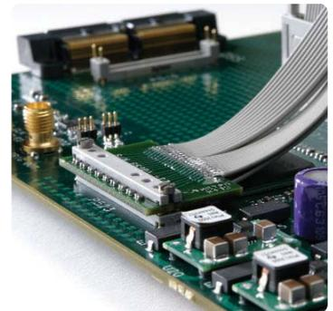
図1. ソフト・タッチ・コネクタレス・プローブは、Agilentの全ロジック・アナライザ製品に使用できます。
