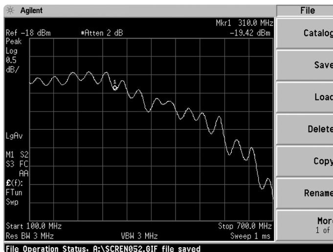
図4. 図1に示されているセットアップを使用したミキサの出力パワー測定
