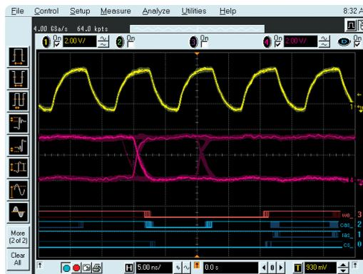
図2：6チャンネル測定: RAS、CAS、WE、CS、CLKでの書き込みトリガをかけたときのデータ・ライン
