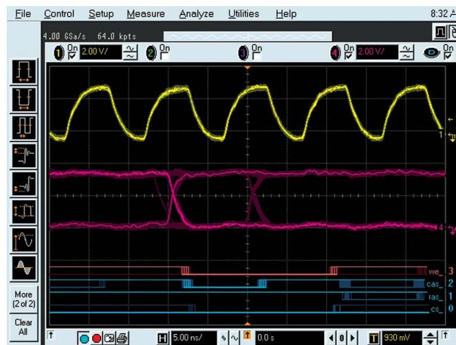
Figura 2: Medição com seis canais: Linha de dados durante um *trigger* de escrita em RAS, CAS, WE, CS e CLK.
