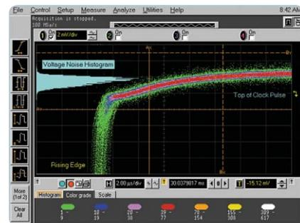
Figura 10. Os projetistas de circuitos digitais normalmente usam medições como a geração de histogramas para avaliar a integridade dos sinais.
