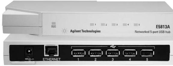
運用 LAN 來存取含有 USB、GPIB 或 RS-232 介面的遠端儀器或裝置
