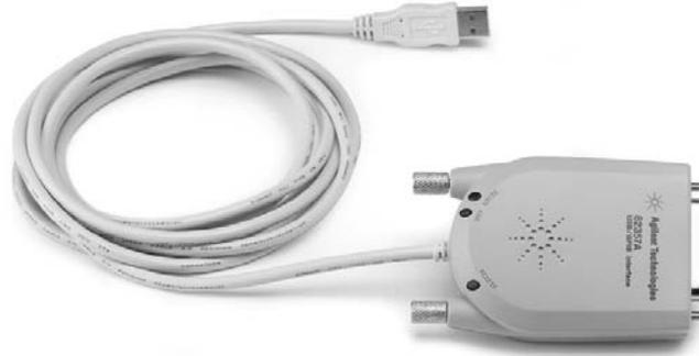
透過 PC 上的 USB 埠快速地連接到 GPIB 介面上
