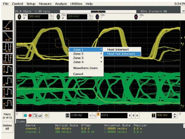
図7. “Must Not Intersect”ゾーンをDQS波形画面に描き、アイドル・ステート信号を取り除きます。
