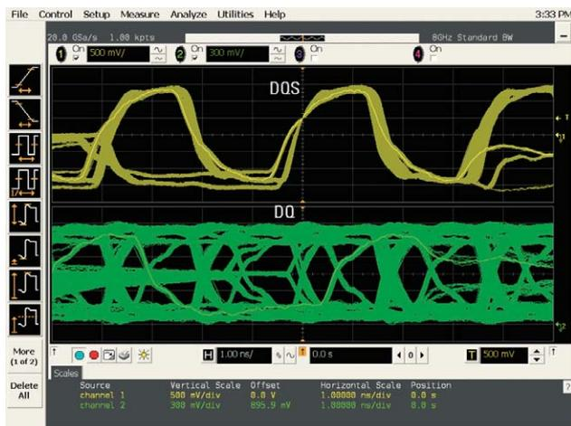
図6. 読み込み信号と書き込み信号のそれぞれのパターンを無限残光モードで表示したDDR信号
