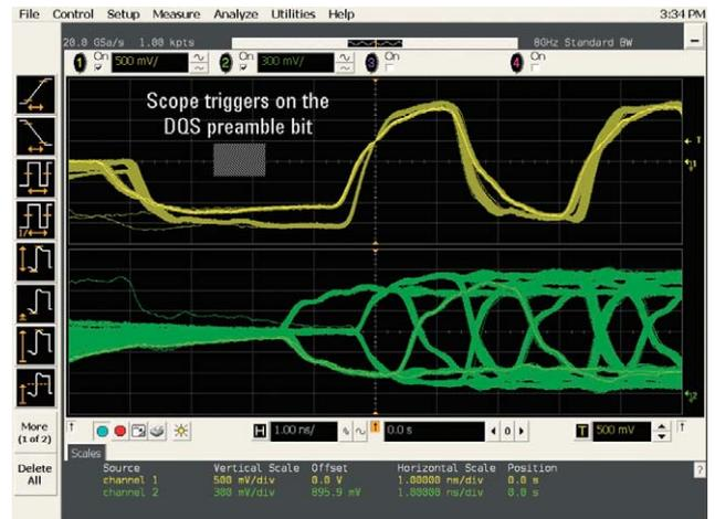
図8. “Must Not Intersect”ゾーンを描いて、読み込み/書き込み信号のプリアンプルをオシロスコープでトラッキングします。
