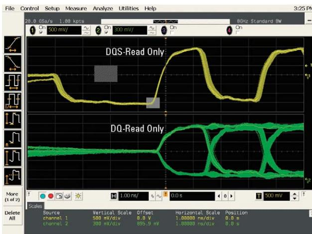
図9. “Must Intersect”ゾーンを電圧が低い方の波形のプリアンプル・ビットに描いて、読み込み信号のみをトラッキングします。
