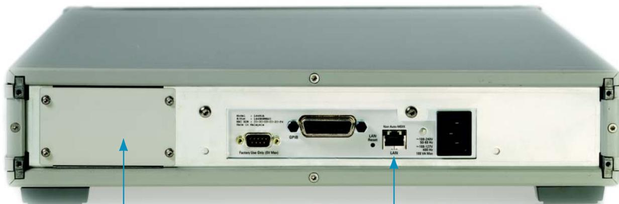
可拆卸后面板用于安装 RF 接头
