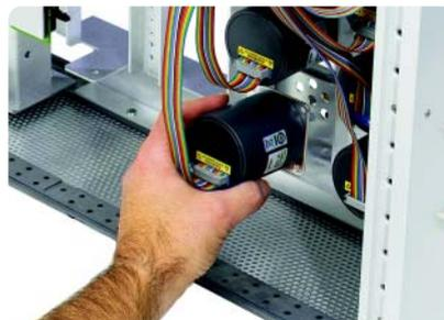
图5. 容易地维修仪器，并且不影响射频电缆
