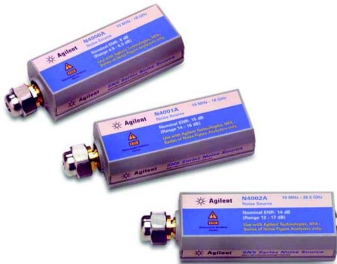
SNS 系列智能噪声源可用于 X 系列信号分析仪 (MXA/EXA)、专用的噪声系数分析仪 (NFA) 和 ESA 频谱分析仪进行噪声系数的测试。虽然 SNS 噪声源的 ENR 输出和频率范围是和传统的 346 系列噪声源是一样的，但是，它们还有另外的优点。首先，SNS 系列的 ENR 数据存储在 EPROM 中，并可自动下载到仪表上，省去了把每个频点上的 ENR 数值用手工的方法输入到校准表中的麻烦。第二个很重要的好处是它们装有内置的热敏电阻，可以不断地向分析仪提供更新的正确的温度信息，借助自动温度补偿和校正而得到更精确的测量结果。
