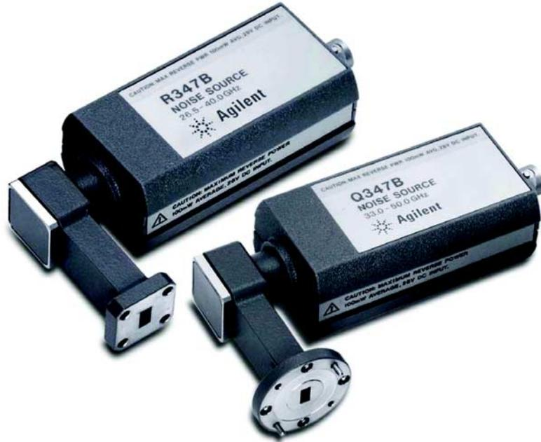
这些波导噪声源可以帮助您非常方便地对毫米波器件的噪声系数进行精确的测量。347系列在被测系统或者组件输入端提供非常精确的宽带噪声，然后由噪声系数表对系统中频上的噪声功率通断比进行处理，从而给出精确的噪声系数和增益的测量结果。这些噪声源具有相当好的ENR时间稳定性，这样，要经过很长的时间才有必要重新进行重新校准，同时，噪声系数测量结果的精度也更高了。
