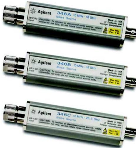
传统的并且最具成本效益的噪声源是346系列, 这一系列的噪声源适用于安捷伦科技的所有噪声系数测试解决方案。346 系列是根据频率范围和 ENR 进行分类的。一些有源器件对端口匹配敏感, 不同的源阻抗会使它们显示出不同的噪声系数。当噪声源的状态从 THot (热态噪声) 转换为 TCold (冷态噪声) 时, 噪声源的端口阻抗 (SWR) 会改变。像 346A 这样的噪声源内部有专用的输出电路帮助把这种因为阻抗的变化而产生的影响降低到最小的程度。
