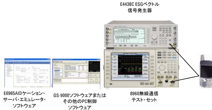
図1 モバイル・デバイスの A-GPS テスト・システムの接続図
