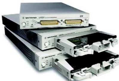
图 14: L4400 系列开关仪器的 3 种模块
