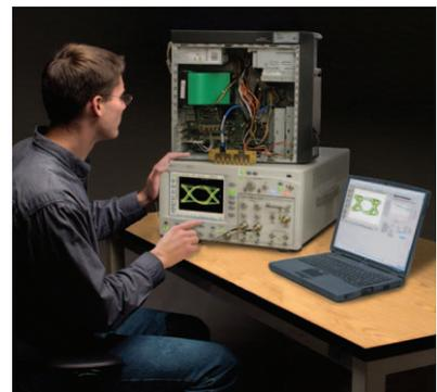
図2：86100C DCA-J と 86100CU-401 アドバンスド・アイ解析ソフトウェアの使用例
