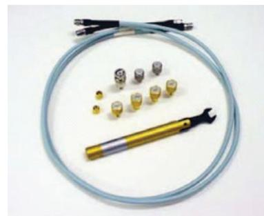
N1024A TDR 校正キット。3.5 mm 精密校正標準(ショート、ロードのそれぞれオスメス 2 個ずつ等から構成)により、さらなる高精度 TDR 校正が可能。
