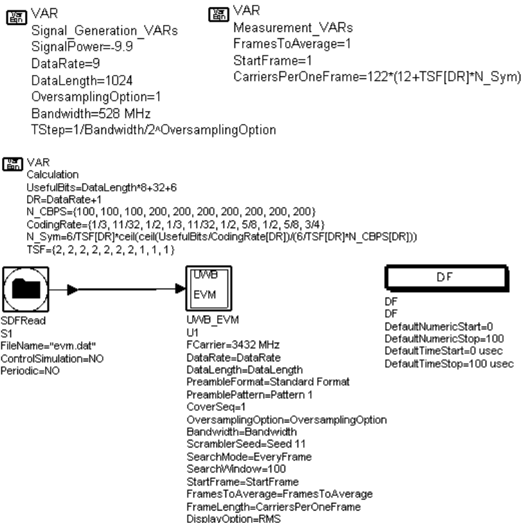
Figure 8-10. UWB_OFDM_TxEVM_TruncatedSignal.dsn Schematic
